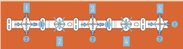
WICHTIG: IM 2. UND 4. "KREUZMODUL" WERDEN KEINE SPIKES FÜR DIE MITTELREIHE GESTECKT, DIESE BLEIBEN IN LÄNGSRICHTUNG LEER. BITTE ACHTEN SIE AUBERDEM DARAUF, BEI DEN MODULEN 1, 3 UND 5 ZUERST IN LÄNGSRICHTUNG (1) ZU STECKEN, DAMIT DIE UNTERSEITE EBEN WIRD UND DIE SCHIENEN PERFEKT AM UNTERGRUND HALTEN. DANN QUERRICHTUNG (2).
